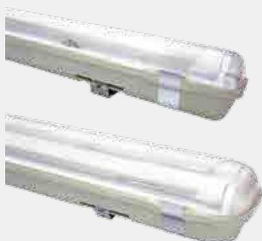
LED-Feuchtraum-Wannenleuchte GP 135 für LED-Tuben ohne VG, Fassungen auf Netzklemme verdrahtet. VDE-Direktive EK1-AD05 entsprechend. Leuchtgehäuse aus hellgrauem, verstärktem Polyester. Wanne gepert aus opalem gasfaserverstärktem Acrylglas PMMA mit verschiebbarem Gelenkverschluß
